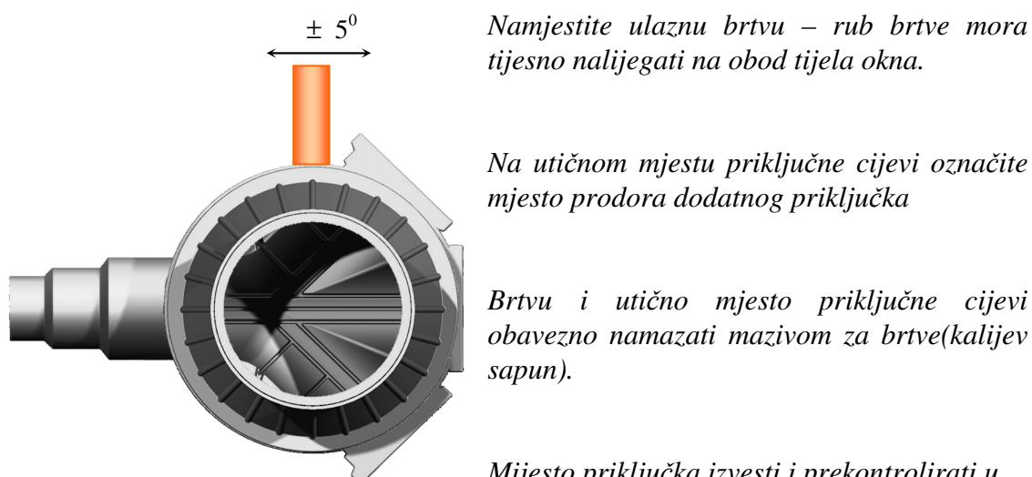
*Ulagana brtva omogućava smicanje dodatnog priključka do  $\pm 5^\circ$ !*
