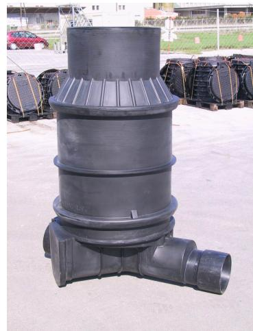
*Okna su izrađena u skladu s smjernicama osnutka standarda pr EN 13598: Plastični cijevni sistemi za podzemnu drenažu i kanalizaciju. Nazivni promjer okna označava unutarnji i promjer, kinetička okna je izvedena skladno sa standardom DIN V 4034-1 (travanj 2003).*
