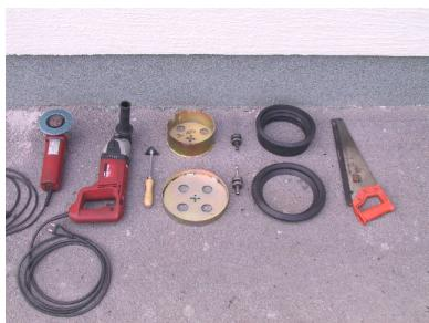
Pribor (ručna el.bušilica,el. brusiča, pila, krunsko svrdlo, adapter, svrdlo  $\phi 6$ , ulazna brtva i mazivo)
